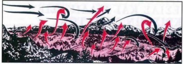
ΣΧΗΜΑ 4 Δημιουργία δινών λόγω θέρμανσης της επιφάνειας του εδάφους.
